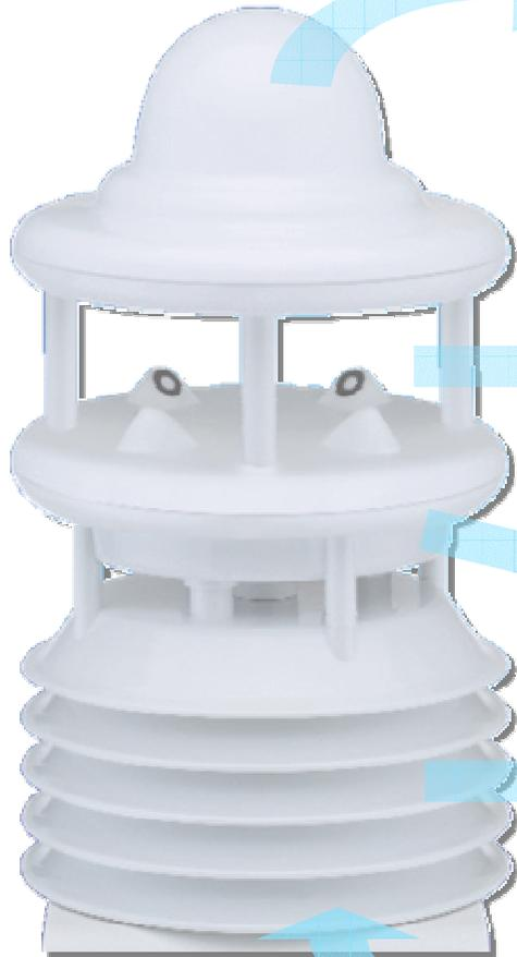
Innovatives Meßprinzip (**R<sup>2</sup>S**) für Niederschlag mit einem **Microwellen Doppler Radar**.
