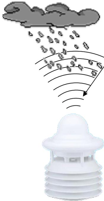
24 GHz Microwellen Doppler Radar misst Geschwindigkeit und Dimension der Niederschlagspartikel um die Art und die Intensität zu bestimmen.
